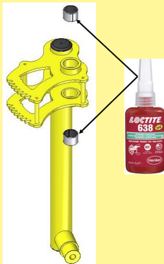
Abbildung 5: Neue Lager am Arm einkleben
