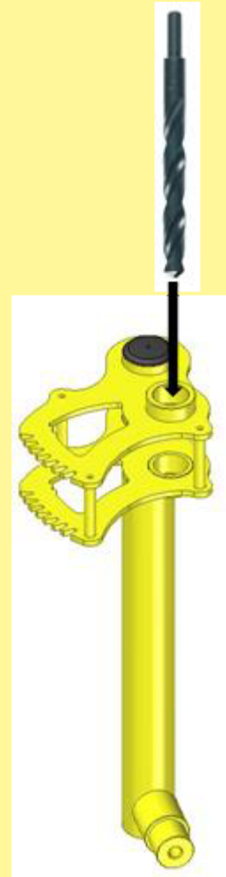
Abbildung 3: Büchsen am Arm aufbohren
